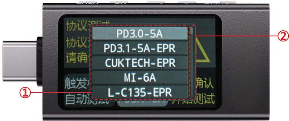
说明：此处的品牌信息对应的各家私有数据线存储的信息，开启的时候可以触发对应的私有协议，或者仅仅模拟品牌信息后使用普通数据线+表模拟成私有数据线使用，具体的作用是使用公头诱骗的时候无数据连接的时候获取最大测试档位，或者使用母座诱骗的时候使用无芯片的数据线获取最大档位，**此处模拟的信息可能超出实际数据线最大能承载的电流。**
