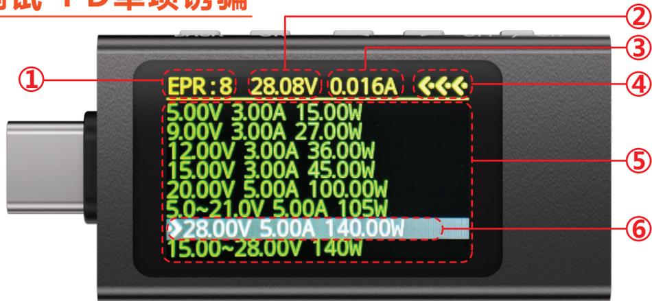
**说明：**此处（+/-）选中的档位不会立即触发，需要再次按下（确认键）确认诱骗，才会同步显示至顶部+执行操作。显示颜色（红色+绿色）同步上述的逻辑。
