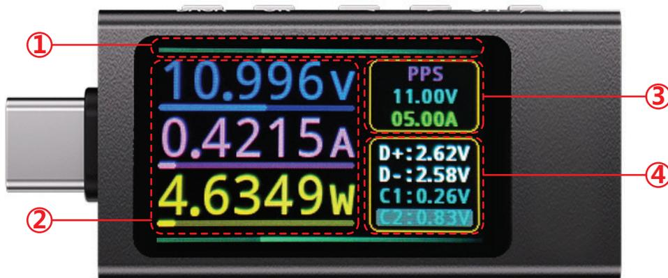
1. 电流方向指示流水灯 颜色随着功率大小变化（绿 -> 紫）。
